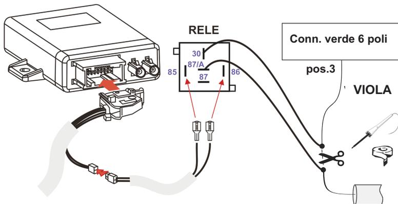
**COLLEGAMENTO DA ESEGUIRE SOLO SE SI INSTALLA IL MODULO CAN CONVERTER**
